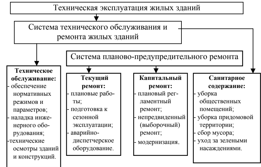
Рисунок 3 - Система технической эксплуатации жилых зданий
